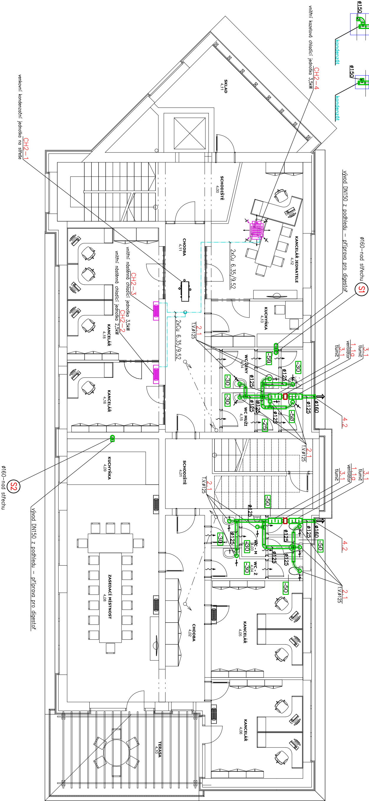
VZT potrubí vedeno v podhledu
